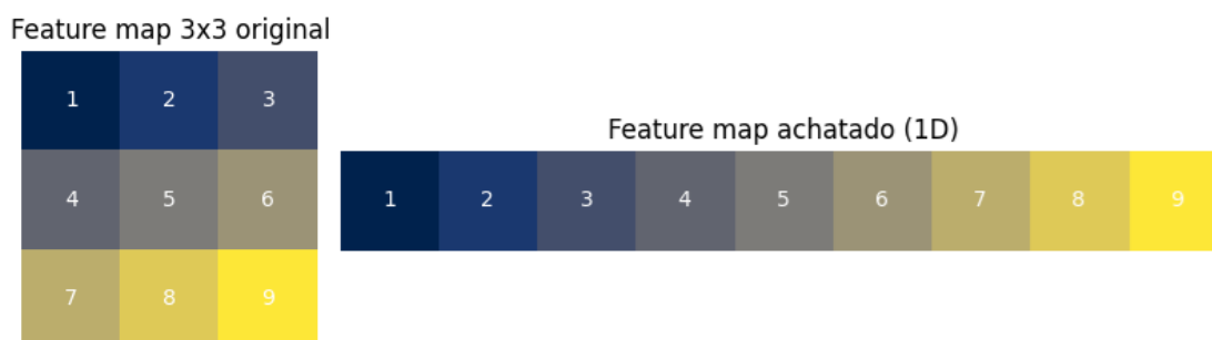
Figura 2.7: Achatamento de um feature map de uma rede convolucional.
