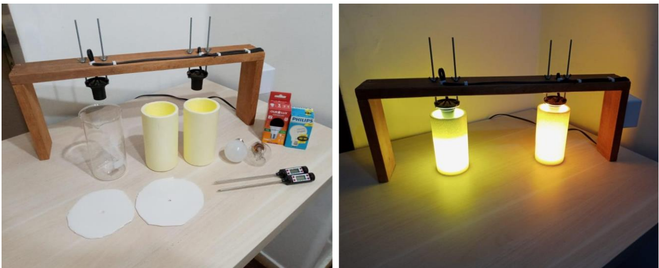
Figura 2: Itens constituintes do experimento das lâmpadas/Experimento em funcionamento.
