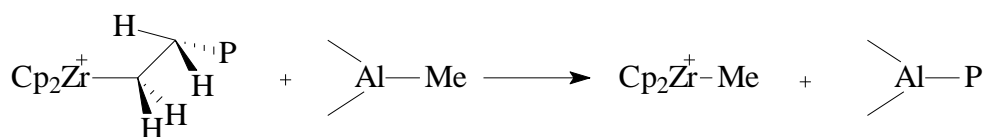
Figura 11. Reação de terminação por transferência de cadeia para o cocatalisador.
