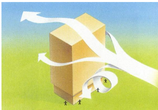
Figura 12: vórtice de pé de fachada (trabalho não publicado) 8
