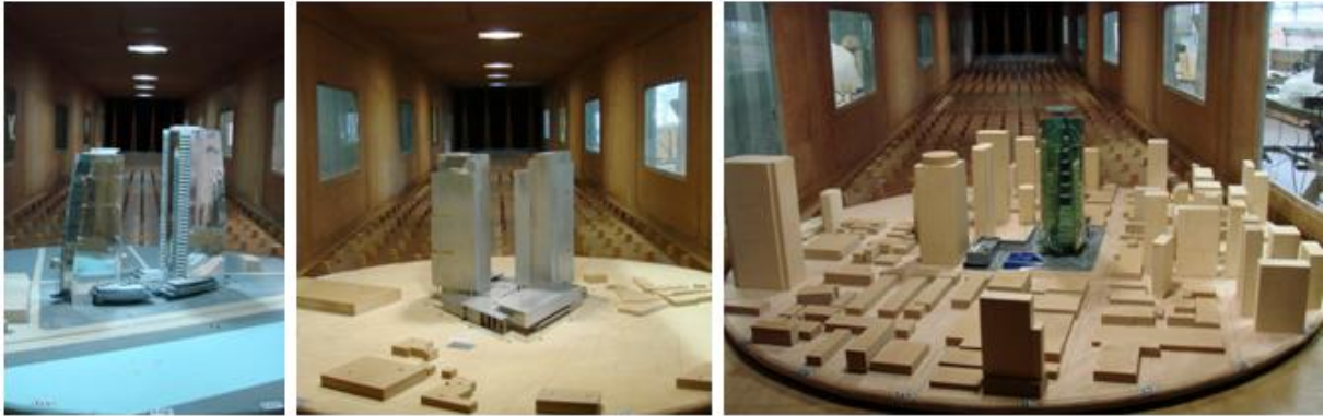
Figura 25: fotos dos modelos dos empreendimentos Brookfield Towers, E-Business Park e Leopoldo Green no interior do túnel de vento
