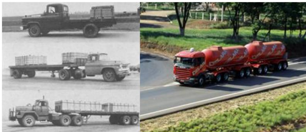
Figura 3: (a) veículos utilizados pela AASHO em pistas experimentais; (b) veículo de carga usado atualmente (FRANCO, 2007, p. 153)
