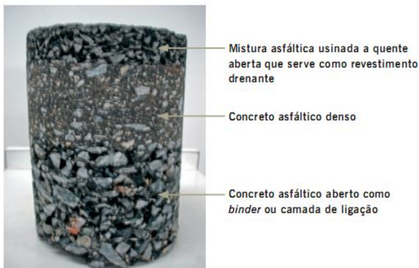
Figura 5: corpo-de-prova extraído de pista mostrando as camadas do revestimento (BERNUCCI et al., 2008, p. 161)
