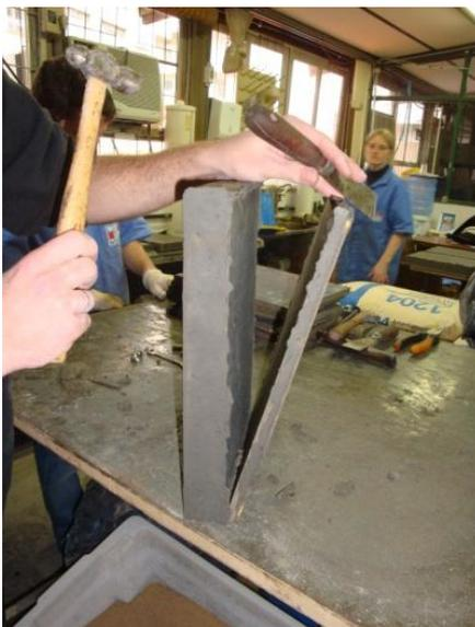
Figura 17: remoção do fundo de fôrma que garantiu uma base homogênea
