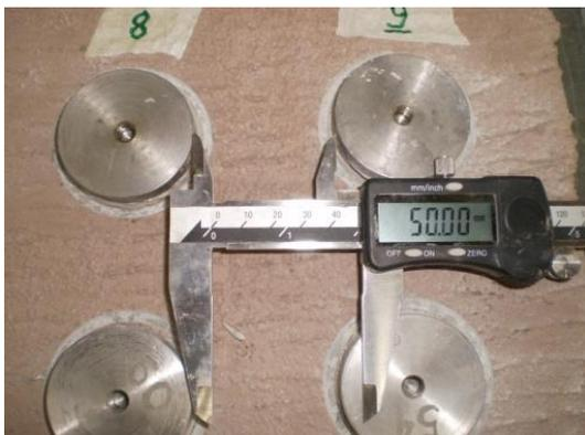
Figura 27: espaçamento de 50 mm entre arrancamentos
