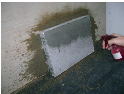
Figura 22: processo de umedecimento do substrato
