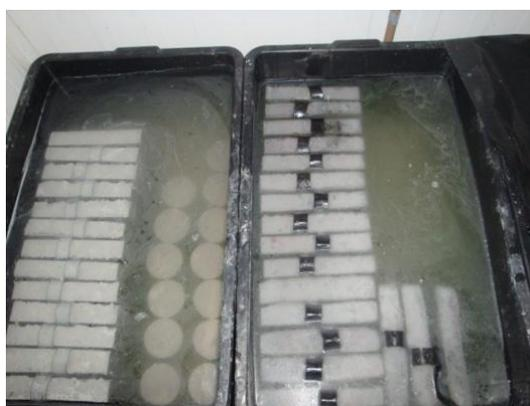
Figura 18: cura submersa dos substratos
