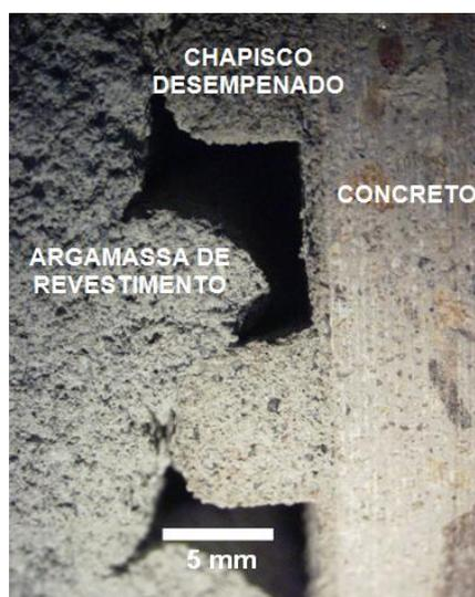
Figura 5: superfície de concreto preparada com chapisco desempenado, para aumentar a rugosidade, gerou uma menor extensão de aderência (PRETO, 2007, p. 164)
