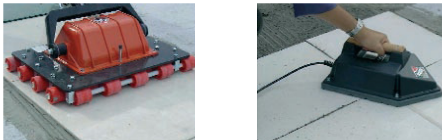
Figura 9: vibrador rolete (à esquerda) vibrador manual (à direita) (PORTOBELLO S/A, 2005, p. 8)
