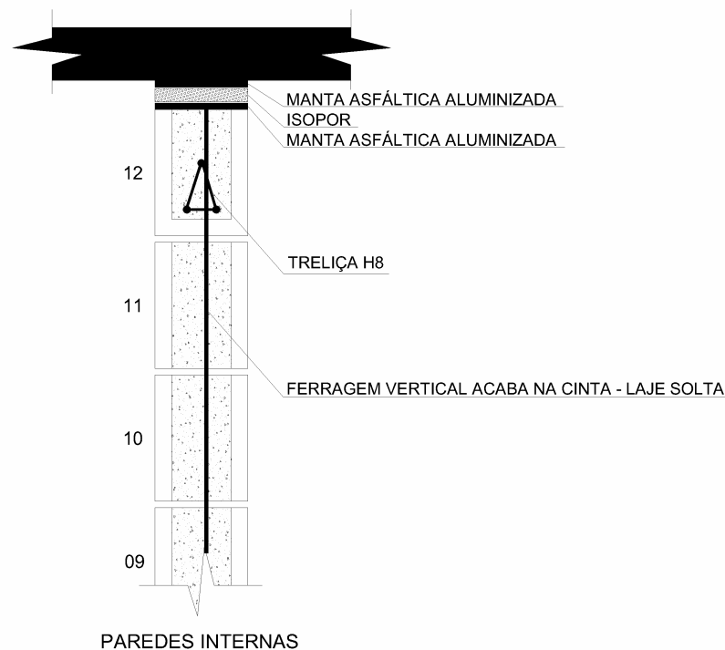
Figura 16: detalhe da separação entre a alvenaria e a laje de forro
