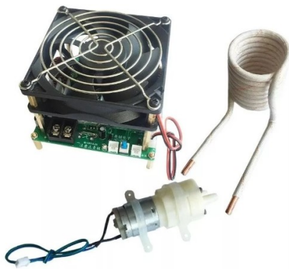
Figura 4.9. Indutor A) Imagem do indutor com a bomba de resfriamento da bobina B) Esquema elétrico da montagem do indutor, fonte de alimentação, relé e wattímetro.
