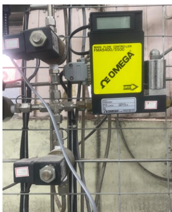
Figura 4.2. Controlador de vazão mássica A) Painel com controlador de vazão mássica B) Tela de operação do sistema supervisorio para controle da vazão
