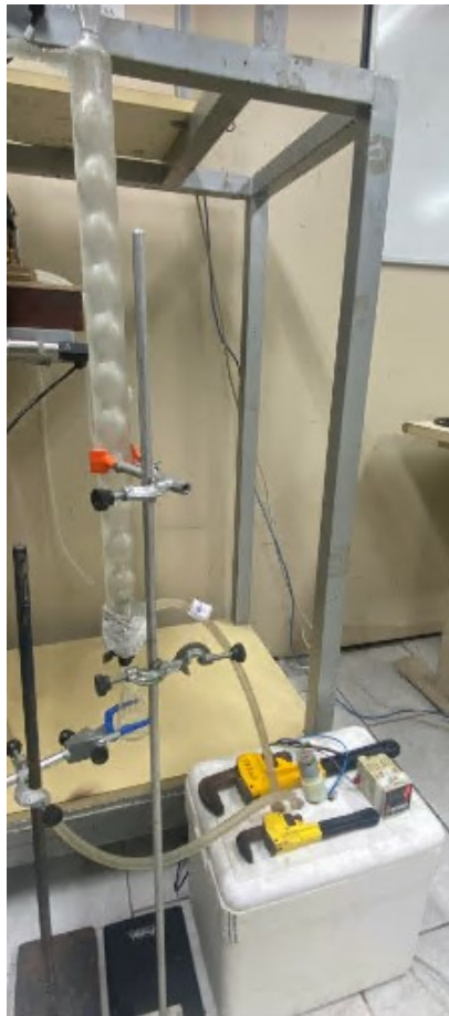
Figura 4.10. Sistema de condensação térmica.
