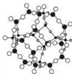
Figura 2.5. Estrutura de uma zeólita. Fonte: LESSA (2012).
