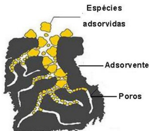
Figura 2.3. Um adsorvente poroso e a adsorção de espécies. Fonte: MARIA (2016).
