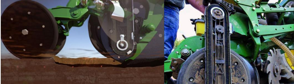
Figura 3 - Sistema desenvolvido pela John Deere: demonstração gráfica de como seria a operação e o condutor com um elevador de escovas
