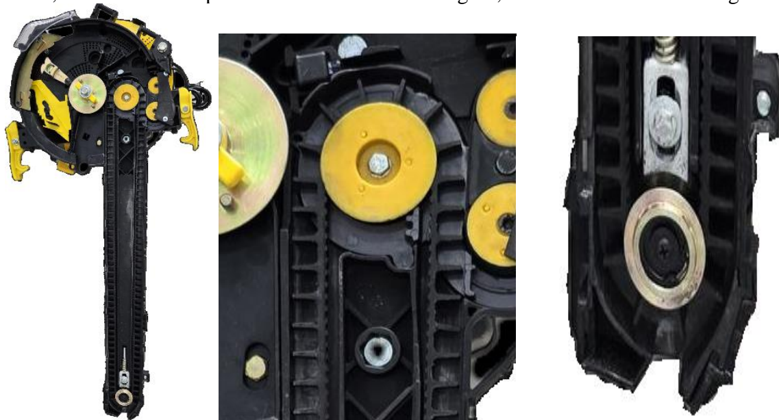
Figura 4 - Visão ampla do condutor com correia de borracha (Fonte: Autoria Própria).
