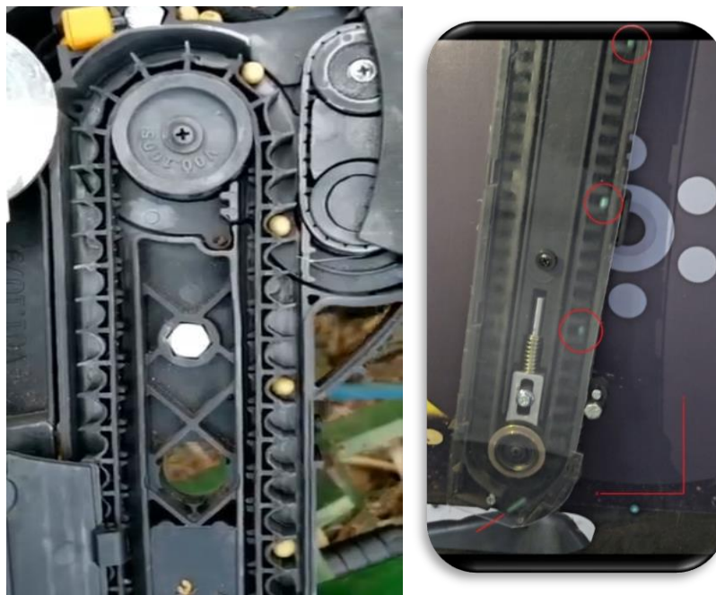
Figura 8 - Imagem relacionando a trajetória de sementes dentro do sistema V Control (Fonte: Autoria Própria).
