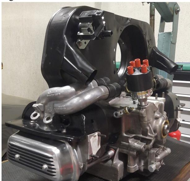
Figura 5: Coletor comercial parcialmente montado no motor. (fonte: Autor)
