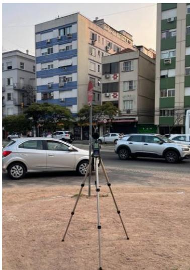
Figura 3 - Sonômetro posicionado seguindo a NBR 10.151:2019 – Fonte: Autora (2024)
