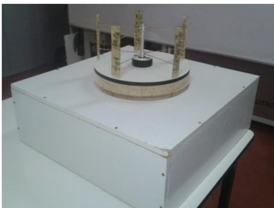
Figura 7 – Rotor da turbina montado sobre uma caixa simulando o topo de uma edificação para a realização dos experimentos. Fonte: Fiabani, 2016.
