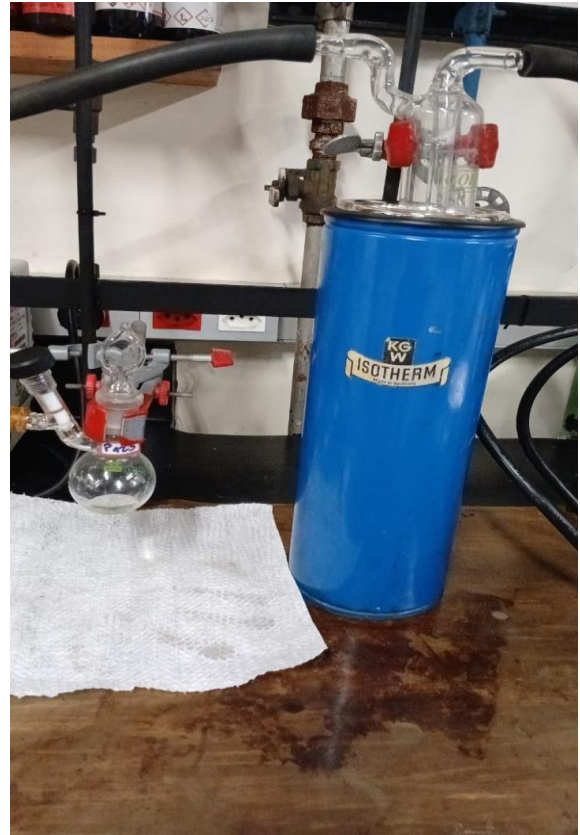
Figura 11 - Sistema de secagem de amostras sob vácuo com trap resfriado por nitrogênio líquido - Laboratório de Reatividade e Catálise, IQ – UFRGS.
