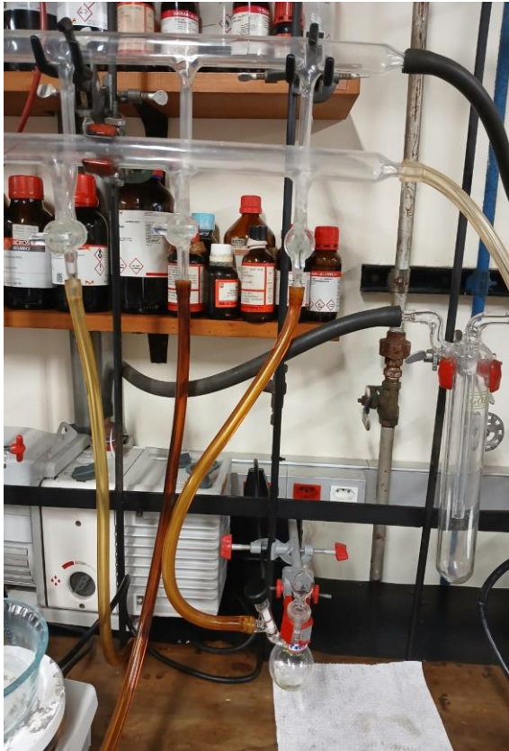
Figura 11 - Sistema de secagem de amostras sob vácuo com trap resfriado por nitrogênio líquido - Laboratório de Reatividade e Catálise, IQ – UFRGS.
