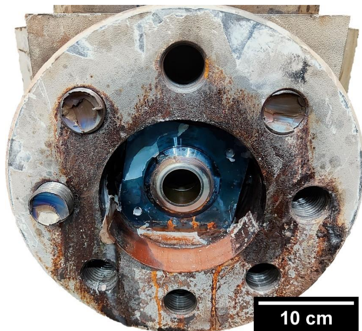
Figura 16 - Um caso de desmontagem da válvula. Junta lens ring acoplada pelos quatro pontos (Fonte: o Autor, 2024)
