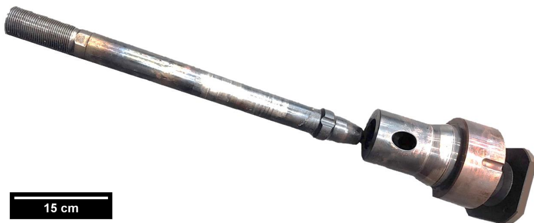
Figura 52 - Alguns componentes da válvula de controle de pressão em sequência de encaixe. Da direita para esquerda: haste/obturador, sede e junta lens ring (Fonte: o Autor, 2024)
