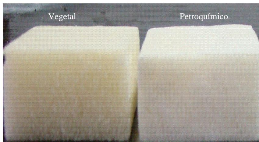
**Figura 5.** Corpos de prova de espumas de PU após teste de *compression set*.
