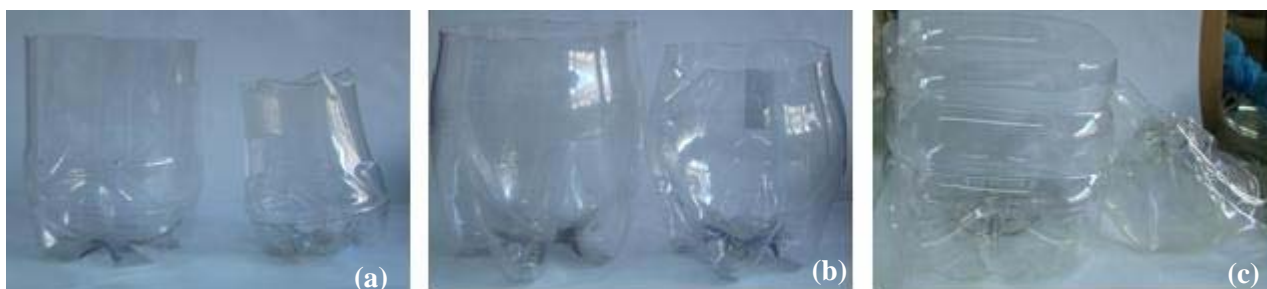
Figura 1 - Embalagens de PET, de 7,5 cm de altura, antes e após exposição em microondas por 50 ciclos. Em (a) 0,5L, (b) 2L e (c) 5L.
