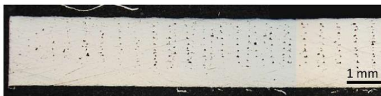
Figura 3.11 Seção longitudinal de uma amostra de aço inoxidável 316L fabricado via manufatura aditiva FDM.
