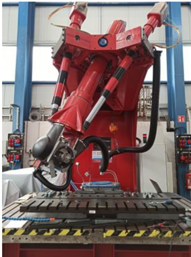
Figura 4.2 - Sistema robótico Loxin PKM T805 Fonte: o autor
