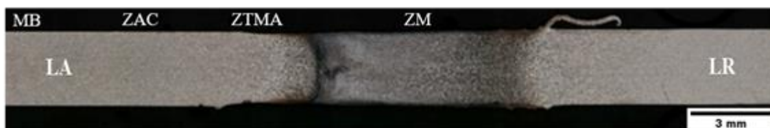
Figura 5.4 – Macrografia de amostra de BT-FSW Fonte: o autor
