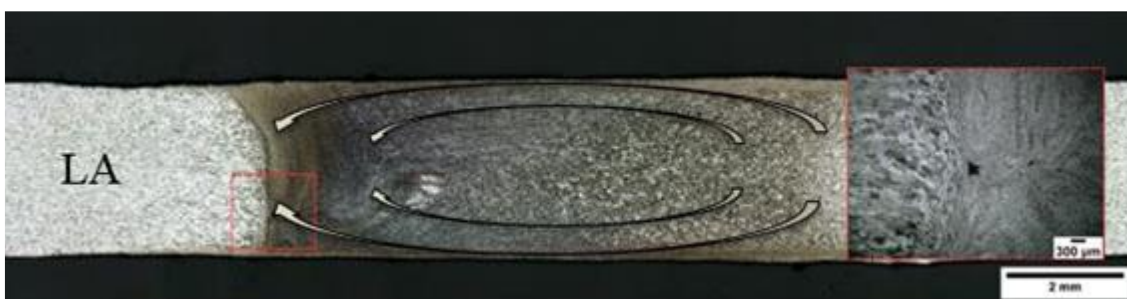
Figura 5.7 – Fluxo de material característico e formação de defeitos
