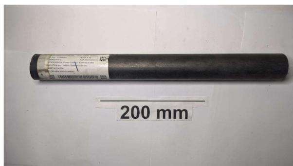
Figura 15. Aço SAE 8630 na condição de recebido, bitola 50mm.
