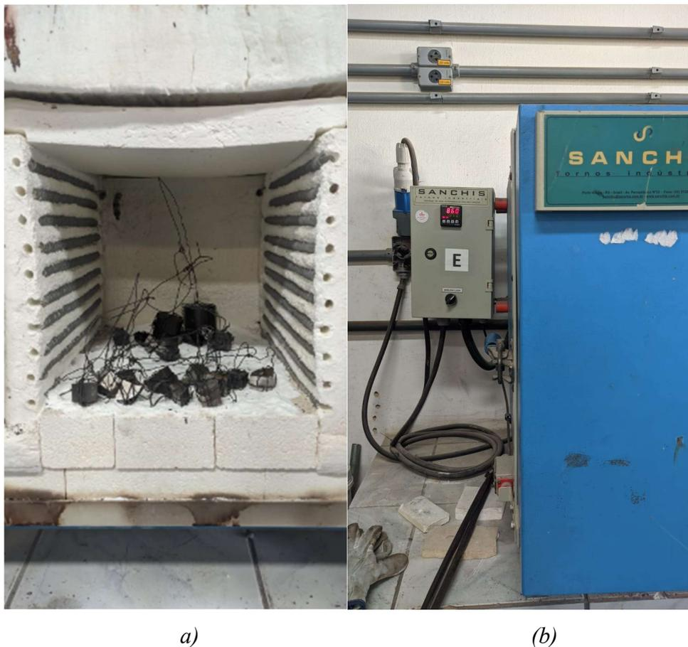
Figura 18. Primeira etapa de tratamento térmico de recozimento isotérmico, em (a) uma das disposições das amostras no forno, em (b) forno a 860°C, temperatura de austenitização.
