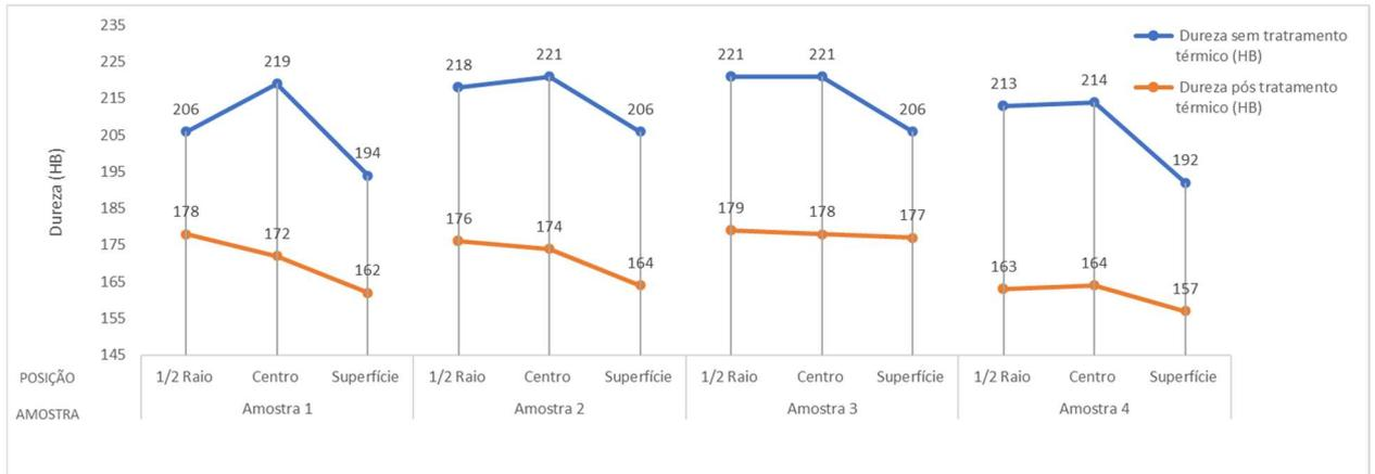
Figura 28. Dureza do material na condição inicial (sem tratamento térmico) e pós tratamento térmico
