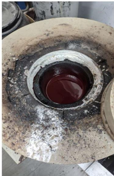
Figura 19. Segundo forno contendo banho de sal fundido na temperatura de patamar
