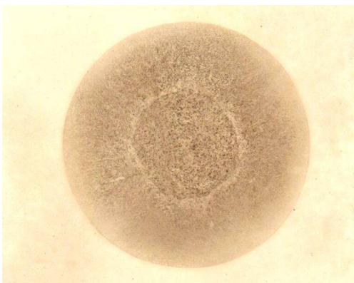
Figura 22. Reprodução por impressão Baumann para seção transversal da barra do aço SAE 8630 antes do tratamento térmico.
