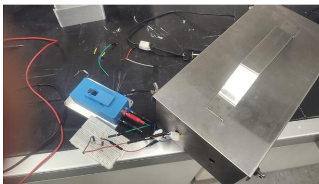
Figura 25 - Potenciostato sem os eletrodos de carbono, conectado a uma protoboard para ter um resistor entre RE e V_{\text{corrente}} e um conector
