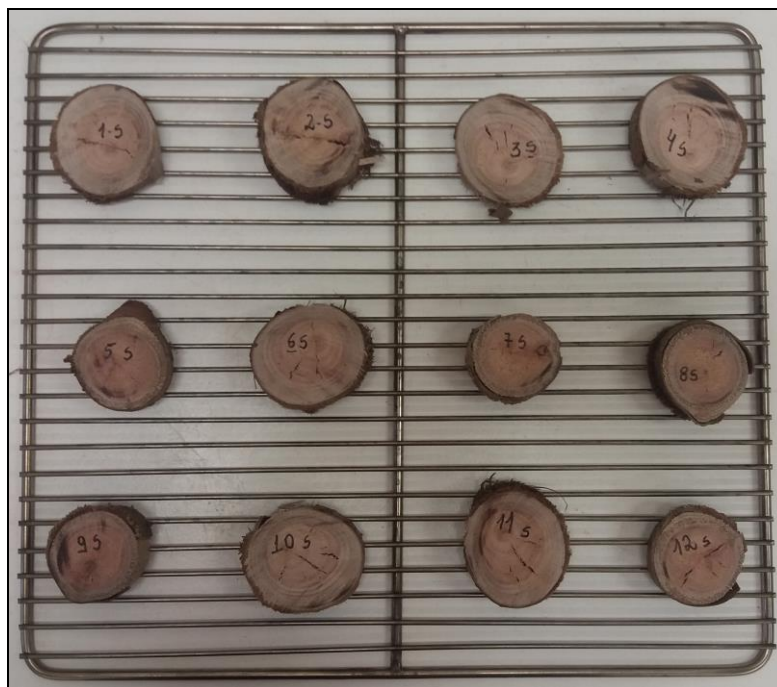
FIGURA 3. Amostras utilizadas para verificar teor de água da lenha.
