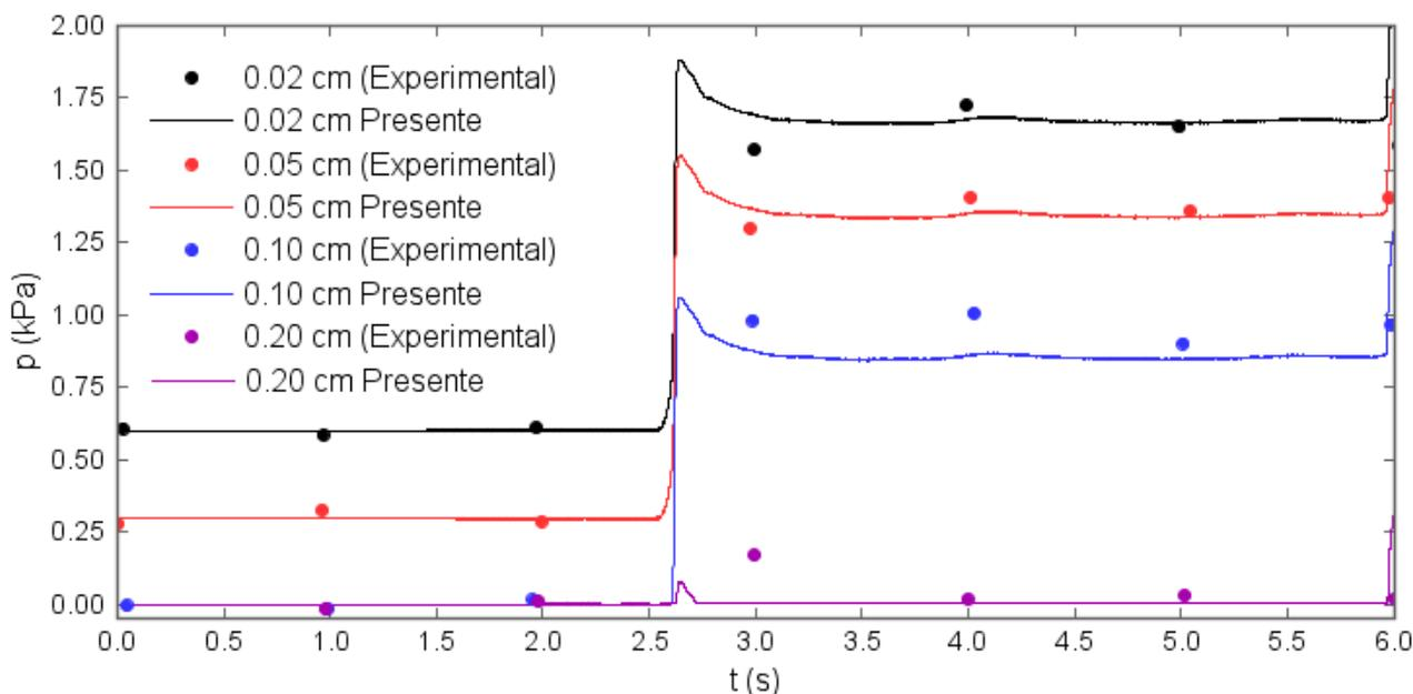
**Figura 5 – Pressão no ponto A do pilar para diferentes profundidades ao longo do tempo.**
