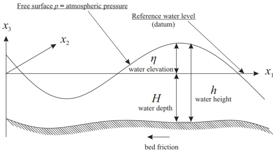
**Figura 1 – Perfil do escoamento de águas rasas.**
