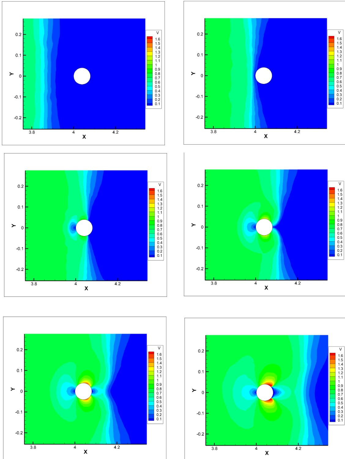
**Figura 4 – Sequência temporal do impacto da onda no pilar: campo de velocidades.**
