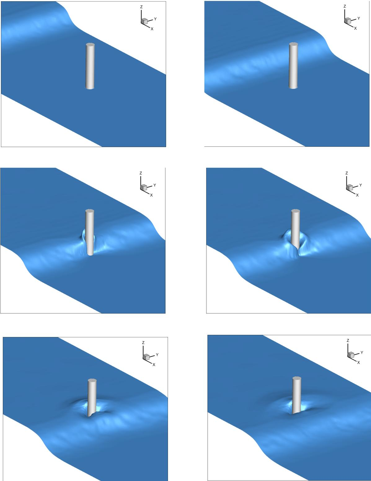
**Figura 3 – Sequência temporal do impacto da onda no pilar: elevação da água.**
