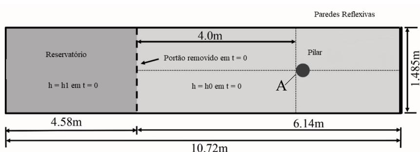
**Figura 2 – Vista superior da geometria, condições iniciais e de contorno do escoamento.**
