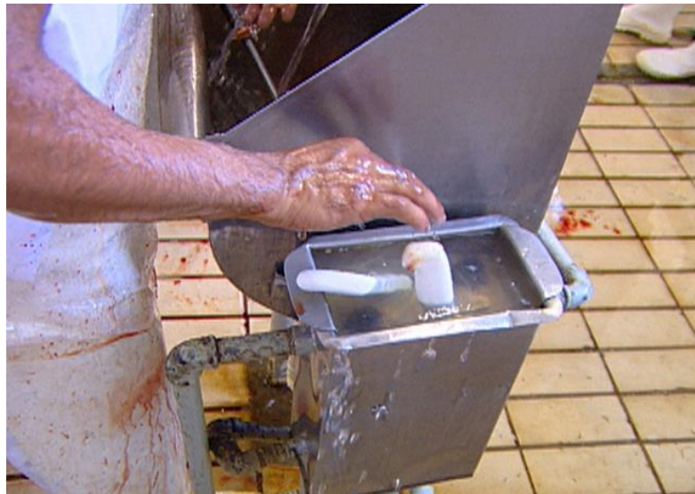
Figura 8 - Limpeza das facas na sangria
