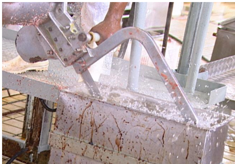
Figura 12 - Lavagem da serra
