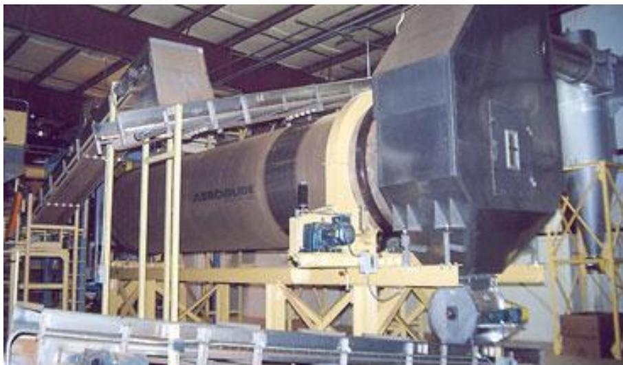
**Figura 3:** Figura ilustrativa de um secador Rotativo (AEROGlide 2010).
