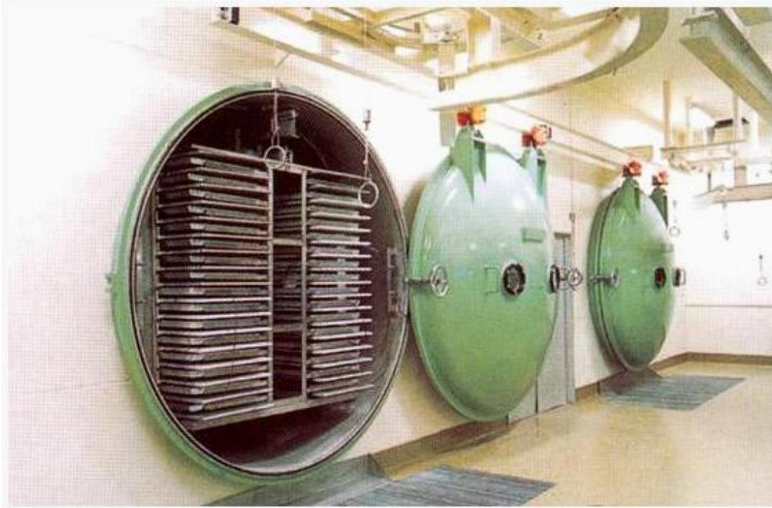
**Figura 5:** Figura ilustrativa de um equipamento industrial de liofilização (AEROGLIDE, 2010).
