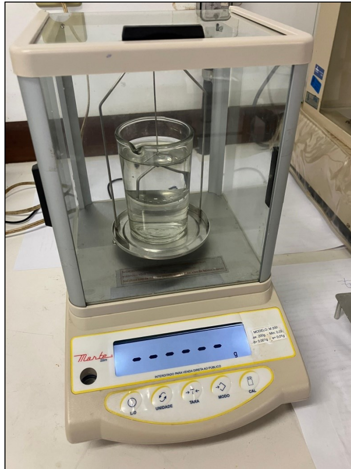
Figura 16: Balança hidrostática de precisão. Para a obtenção dos valores de densidade foi utilizada uma balança da marca Marte, modelo M200. Créditos do autor.
