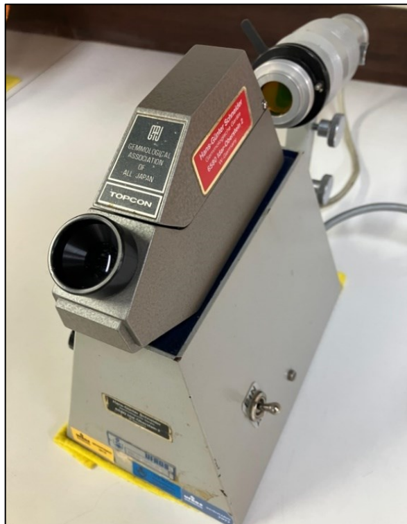
Figura 15: Refratômetro gemológico de contato TOPCON. Equipamento utilizado para a leitura de índice de refração. Créditos do autor.
