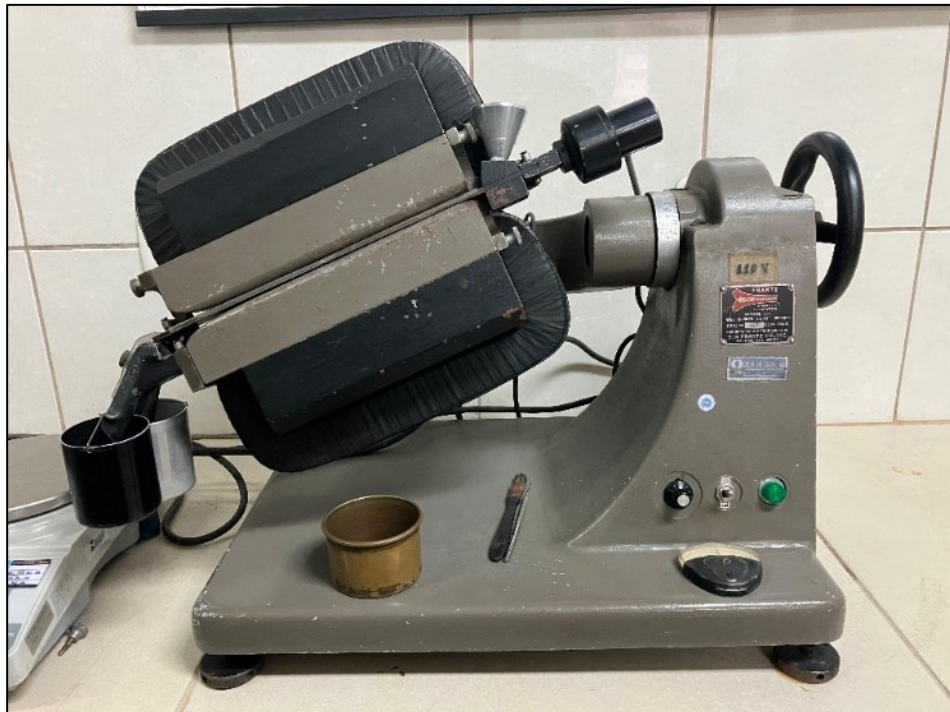
Figura 23: Separador Frantz utilizado para a técnica de separação das inclusões na opala. Créditos do autor.
