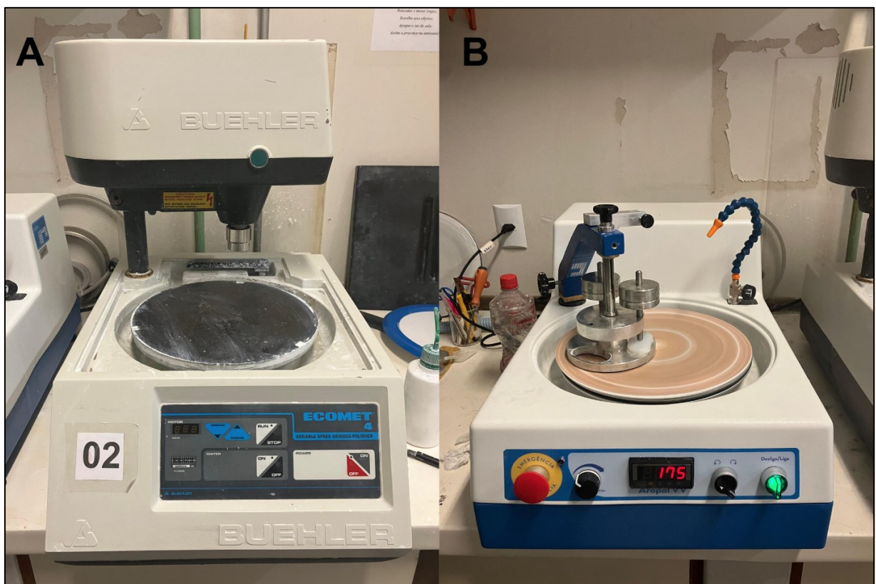
Figura 11: Equipamentos de polimento. Politrizes utilizadas para o acabamento espelhado nas amostras. Créditos do autor.
