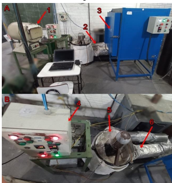
1 – Forno mufla de austenitização. 2 – Dispositivo de austêmpera com ar aquecido. 3 Forno mufla da segunda etapa da austêmpera. 4 – Sistema de controle. 5 – Ventilador. 6 Duto de ar aquecido e câmara de austêmpera. Fonte: Do autor.
