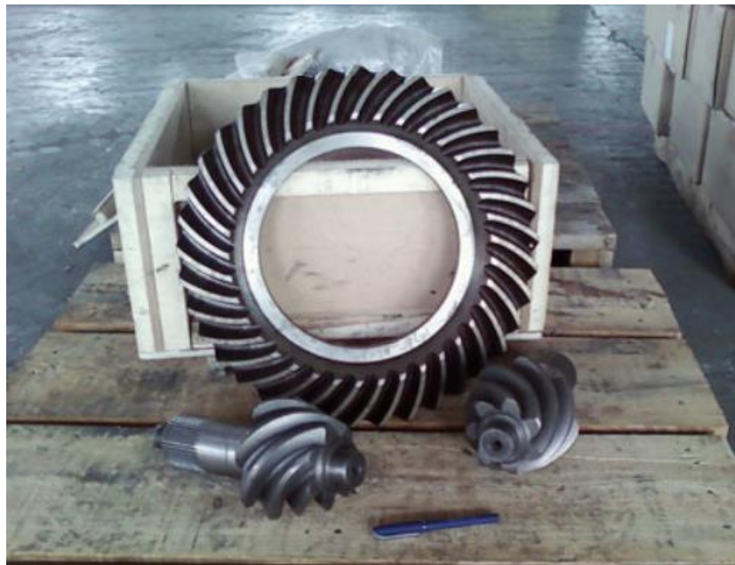
Figura 4 - Exemplo de coroa e pinhão com engrenagens hipoidal de sistema de diferencial fabricados em ADI. Adaptado de (LEFEVRE; HAYRYNEN, 2013).
