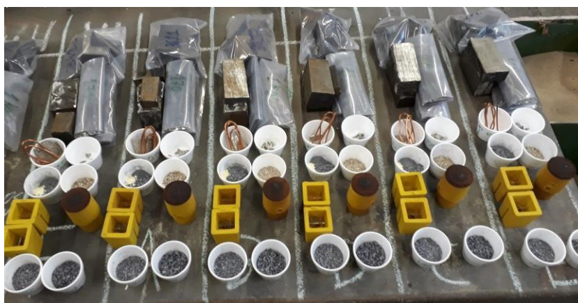
Figura 16 - Insumos e matérias primas utilizados na elaboração das seis ligas de ferro fundido nodular.
