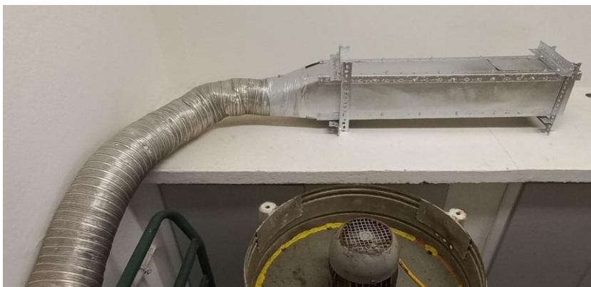
Figura 13 – Modelo físico. Ventilador e duto utilizados para validação da simulação.
