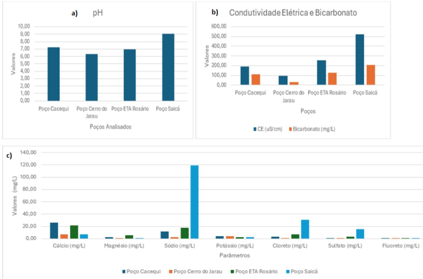
**Figura 13** - a) Média do pH dos quatro poços; b) Médias de Condutividade Elétrica e Bicarbonato; c) Gráfico médio geral dos parâmetros químicos. Elaboração própria.
