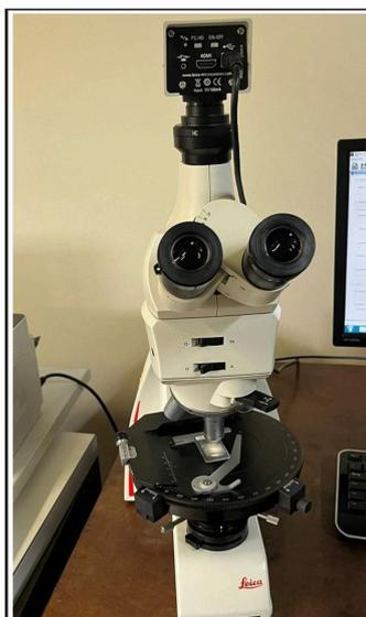
Figura 5. Microscópio óptico do modelo Leica DM750P utilizado para as análises petrográficas.
