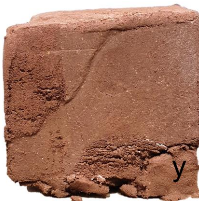
Figura 4.46 – Ensaio cúbico remoldado \alpha=0^\circ , CP ensaiado, vista lateral
