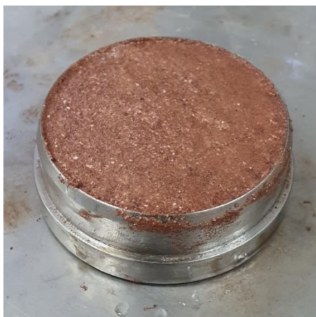
Figura 4.11 – Edométrico: Amostra indeformada ensaiada em imersão
