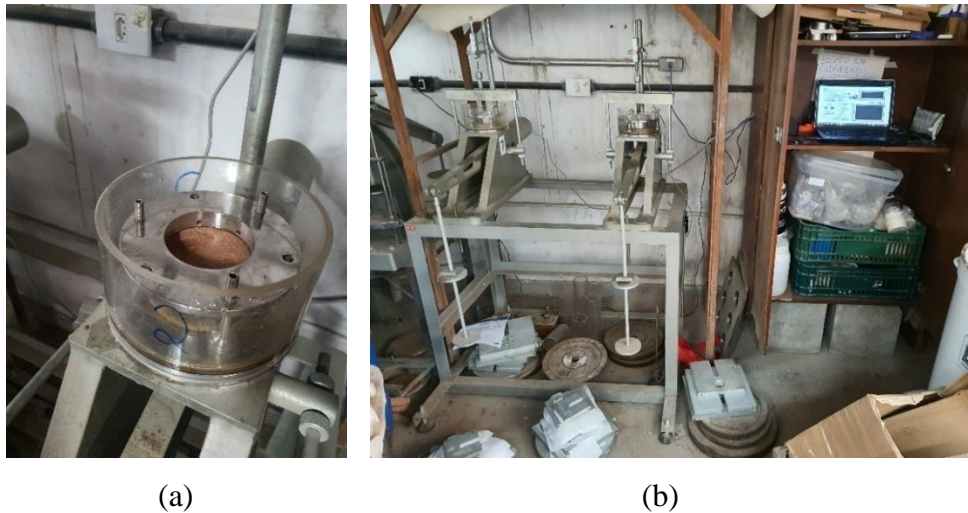
Figura 3.13 – Ensaio edométrico a) Detalhe montagem da amostra b) Ensaio em andamento
