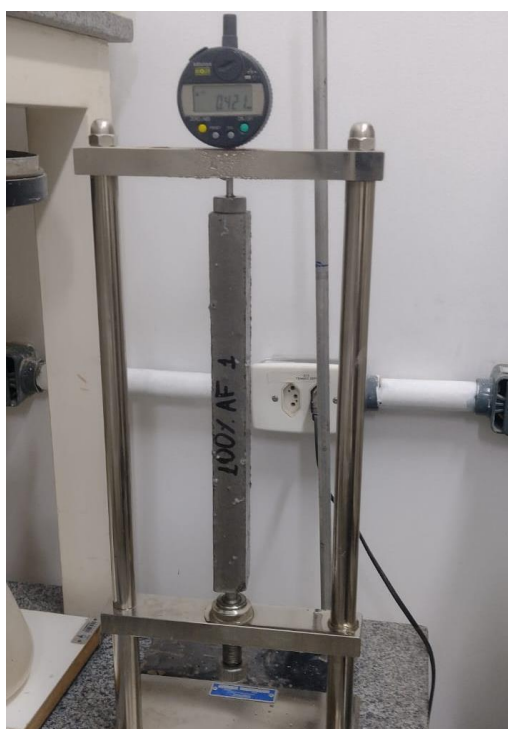
Figura 18 — Leitura das barras de argamassa no comparador de comprimento
