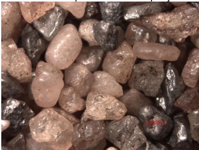
Figura 10 — Aspecto superficial da fração de ADF retida na peneira 1.18mm (imagem obtida em microscópio ótico com ampliação de 0,65x)
