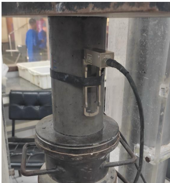
Figura 16 — CP com extensômetros durante o ensaio de módulo elástico
