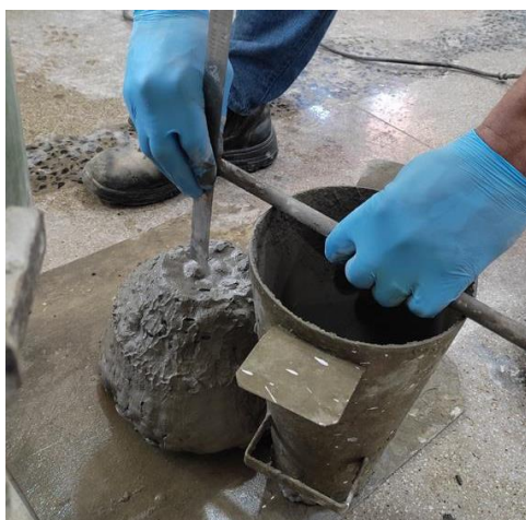
Figura 15 — Ensaio de abatimento Slump test
