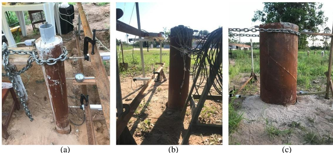
Figura 4.37. Instrumentação de superfície e vigas de referência: transdutores lineares de posição em condição de topo e superfície, fixados em cantoneiras de referência tipo L com uso de sargentos; relógios comparadores colados a vigas de madeira, posições variadas; e giroscópio de três eixos, impermeabilizado e posicionado no topo das estacas a partir de imã N35. Detalhes para as estacas M1Fd (a), M21a (b), e M3Rb (c).
