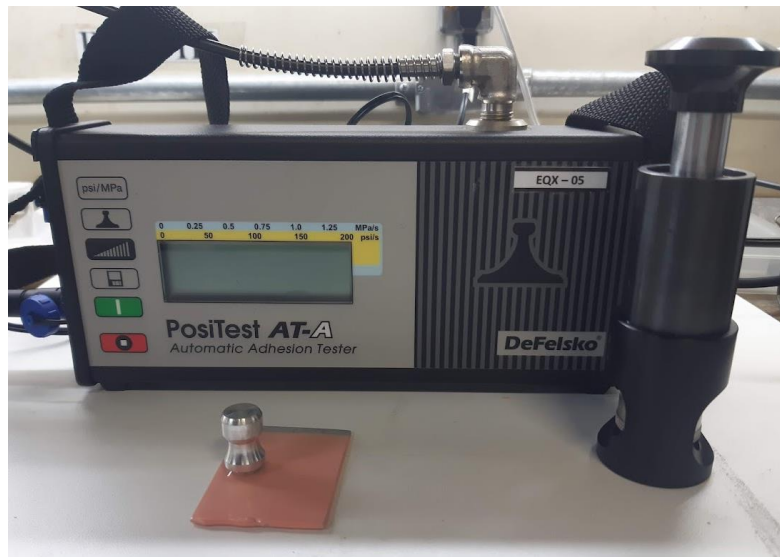
Figura 39 – Equipamento pull-off para medidas de aderência.
