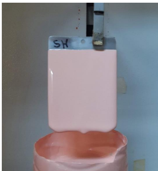
Figura 38 – Amostra sendo pintada pelo método dip-coating.
