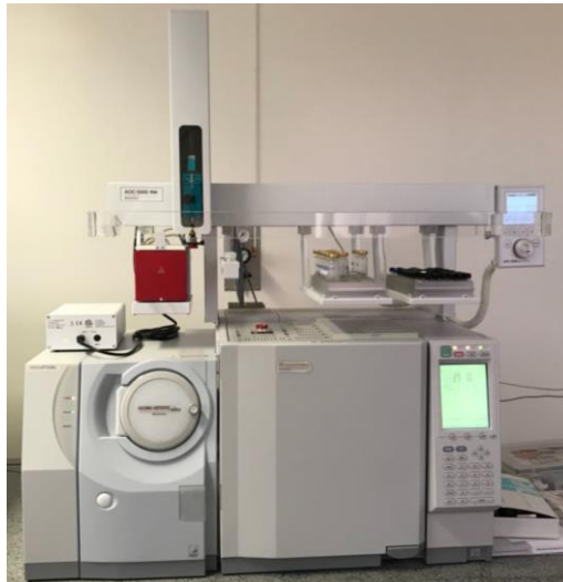
Figura 14 - Cromatógrafo gasoso acoplado ao detector de massas utilizado para determinação dos componentes de óleos essenciais.
