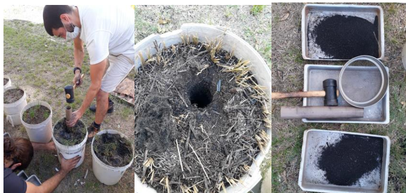
Figura 10 - Amostragem de Tecnoossos e respectivos equipamentos utilizados,
