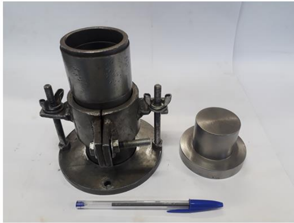
Figura 33 - Molde tripartido para corpo de prova com d = 50 \text{ mm} e h = 100 \text{ mm} .
