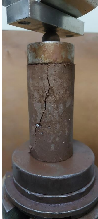
Figura 36 - Ruptura de corpo de prova com 28 dias.
