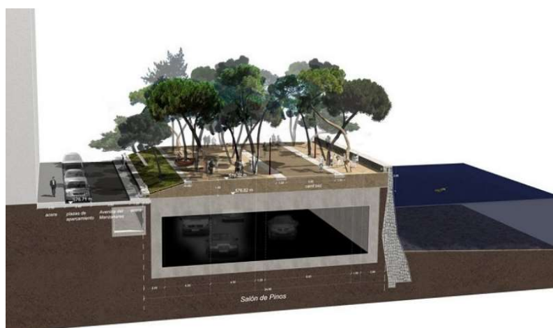
Figura 34 - Corte tipo dos túneis da M-30 no trecho urbano do rio Manzanares
