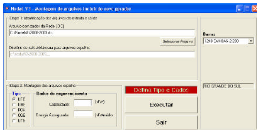
Figura 15 Tela de montagem de arquivo espelho para inclusão de novo empreendimento de geração
