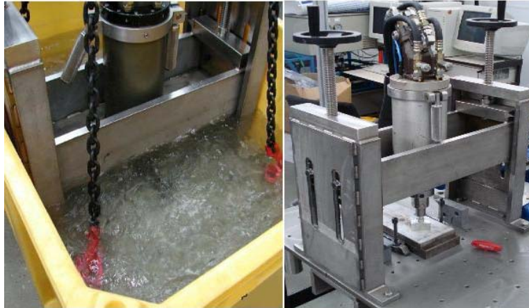
Figura 2.7 – HMS 3000 Em condição simulando ambiente marinho e atmosfera (Ambroziak e Gul 2007).
