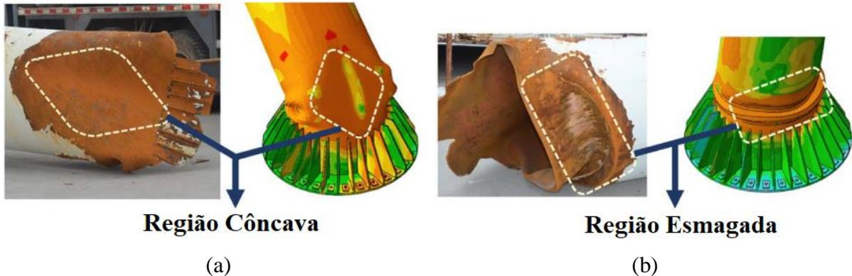
Figura 9 – Caracterização do modo de colapso por flambagem da coluna (a) no lado tracionado e (b) no lado comprimido da coluna próximo à base (adaptado de Wen e Xie, 2020)
