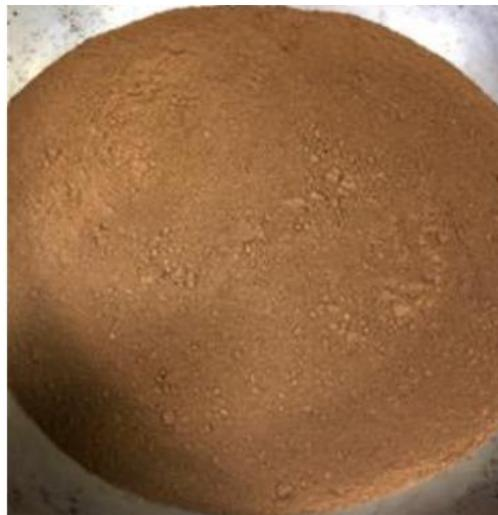
Figura 3.1: Rejeito de mineração de ferro seco e destorroado.
