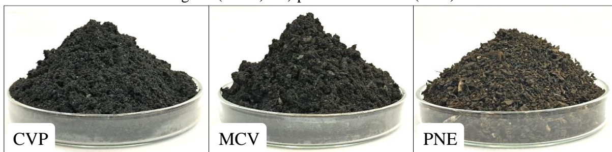
Figura 6.1 – Aditivos estudados: coque verde de petróleo (CVP), b) moinha de carvão vegetal (MCV) e c) pneus inservíveis (PNE)
