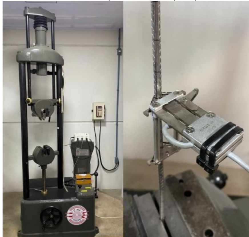
Figura 33 – Máquina de ensaio de tração Losenhausen com capacidade para 10.000 kgf (esquerda) e extensômetro modelo 102, da marca Dinateste (direita)
