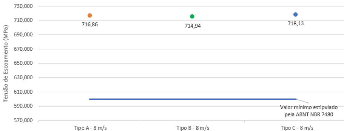
Gráfico 12 – Comparativo dos valores médios de tensão de escoamento dos corpos de prova trefilados com os lubrificantes tipo A, B e C na velocidade de 8 m/s com o valor mínimo permitido pela ABNT NBR 7480
