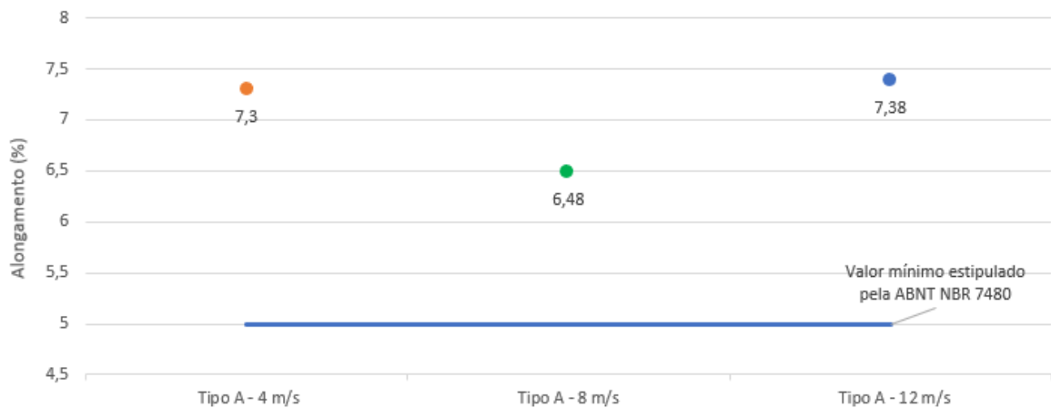
Gráfico 9 – Comparativo dos valores médios de alongamento dos corpos de prova trefilados com o lubrificante tipo A nas velocidades de 4, 8 e 12 m/s com o valor mínimo permitido pela ABNT NBR 7480
