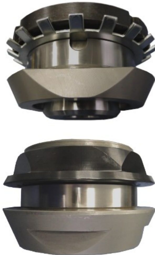
Figura 9 – Mancais rotativos: fixo (acima) e intercambiável (abaixo). Os rolos de metal duro são fixados aos mancais por uma porca de travamento
