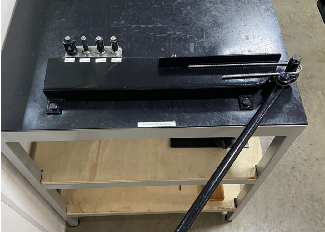
Figura 34 – Dispositivo utilizado para a realização do ensaio de dobramento
