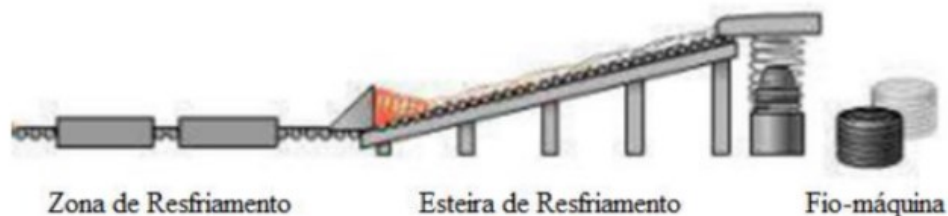
Figura 6 – Processo de produção do fio-máquina por laminação a quente (parte II)
