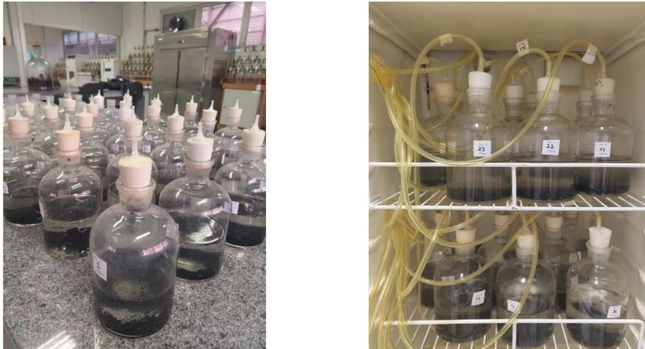
**Figura 1: Reatores anaeróbios em batelada usados nos experimentos**
