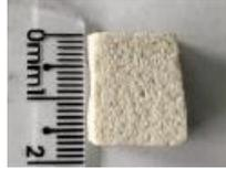
**Figura 1: Foto do suporte utilizado no processo de remoção de nitrogênio: Cerâmica silicosa**
