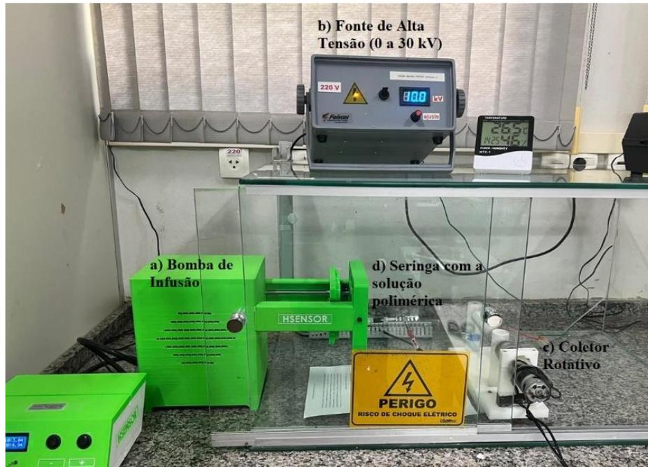
**Figura 1:** Sistema para eletrofição. a) Bomba de Infusão, b) Fonte de Alta Tensão, que varia de 0 a 30 kV, c) Coletor rotativo, d) Seringa contendo a solução polimérica (PS/GO).
