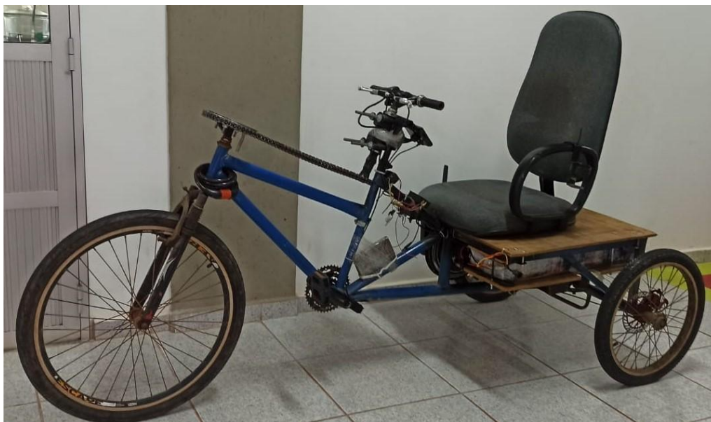
Figura 1: Triciclo protótipo equipado com motor elétrico e câmbio
