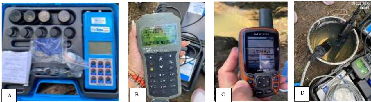
Figura 2: A- Turbidímetro HI98703C, B- Sonda multiparâmetros HI98196, C-GPS Garmin, D- Balde de Inox.
