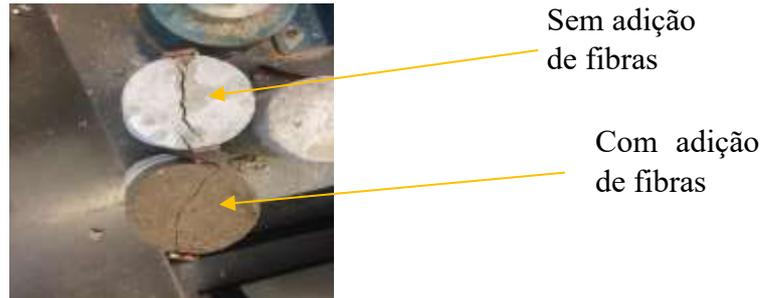
**Figura 8: Fissuras nos corpos de provas.**
