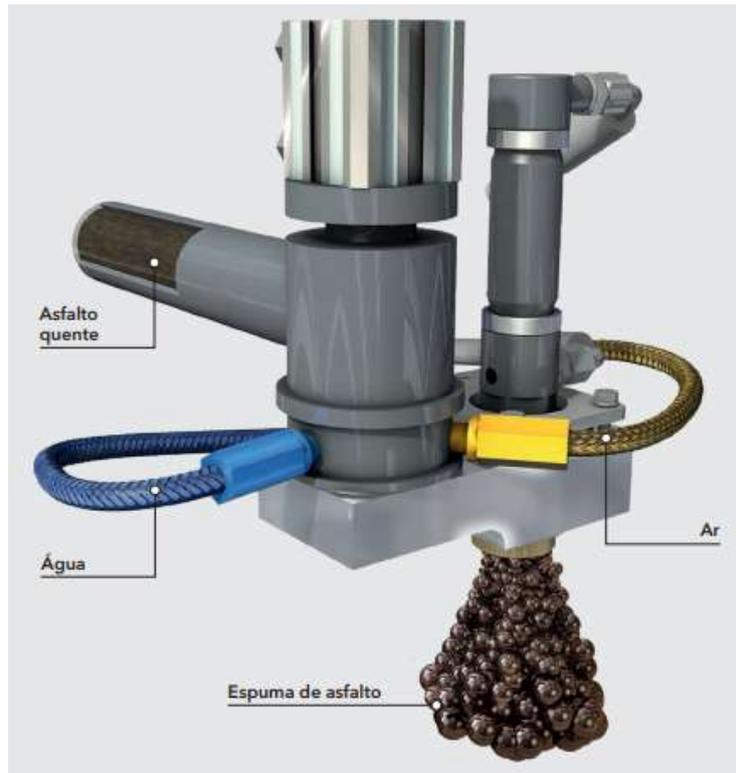
**Figura 2 - Espuma de asfalto produzida com injeção de água e ar no CAP.**
