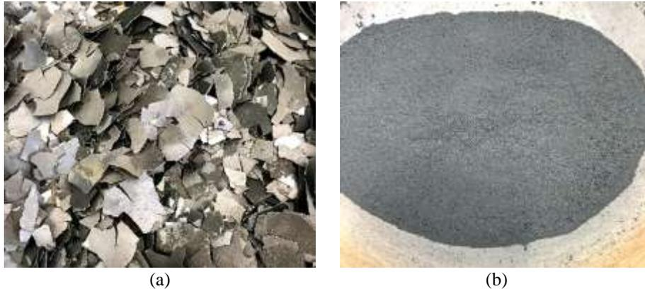
**Figura 2: (a) Cascas de ovos depois da secagem em alta temperatura e em (b) Pó de casca de ovo (Biochar).**
