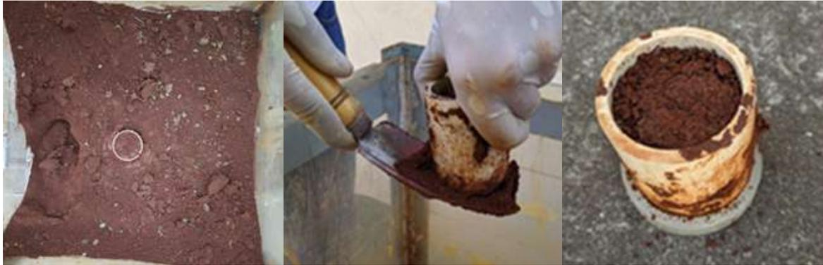
Figura 5. Fôrma de PVC cravada no protótipo para obtenção de amostra semi-indeformada.
