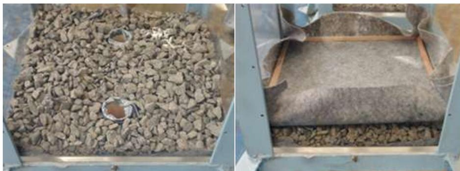
**Figura 1. Brita e manta geotêxtil para montagem da camada de fundo.**
