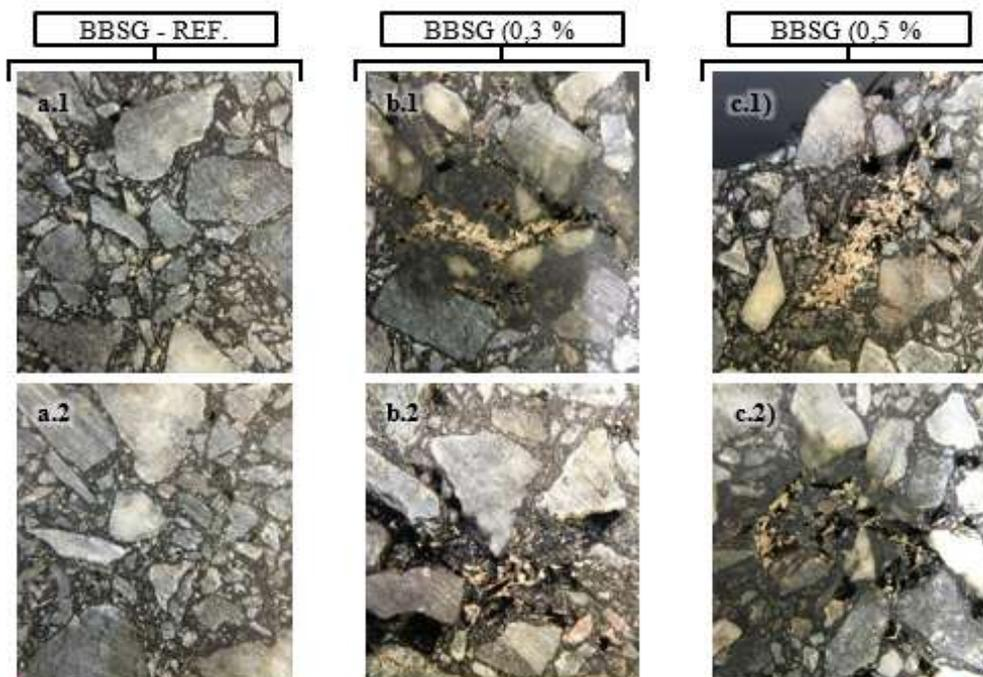
**Figura 9: Arranjo granulométrico verificado através da seção transversal das misturas asfálticas (a.1 e a.2) de referência, (b.1 e b.2) com 0,3% de sisal e (c.1 e c.2) com 0,5% de sisal.**
