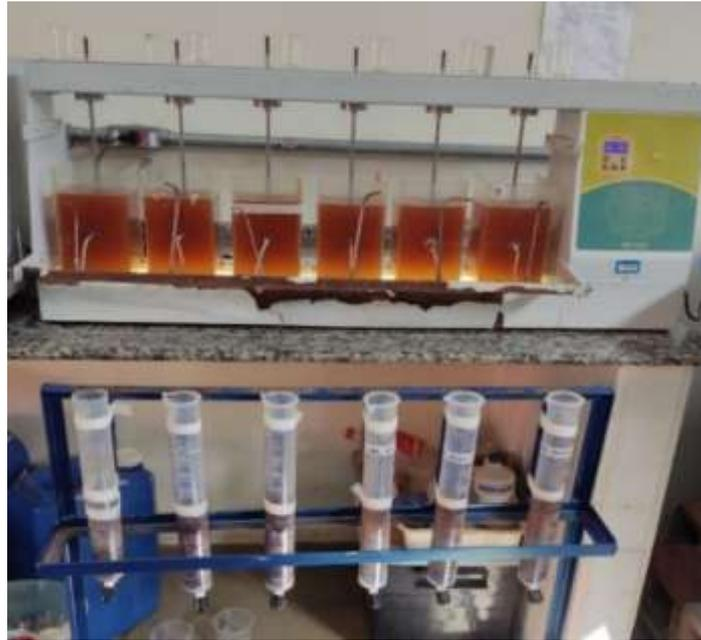
Figura 1 - Jar Test com a água de estudo e os filtros utilizados.
