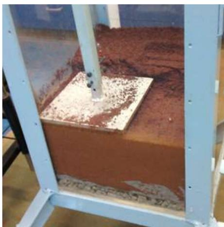
Figura 3. Compactador desenvolvido para as camadas intermediárias de resíduos e suas coberturas.
