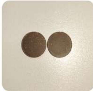
**Figura 5: Pastilhas adsorventes antes da sinterização.**
