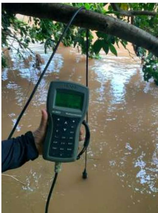
**Figura 3 - Medição dos parâmetros físico-químicos com a sonda Hanna HI9829.**
