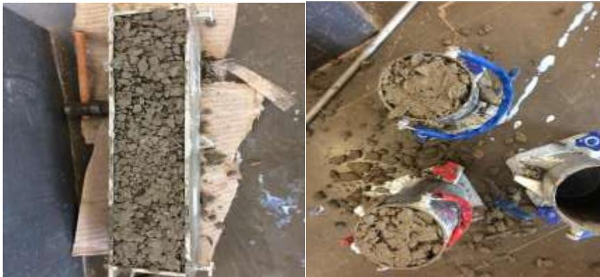
**Figura 4: Corpos de provas e viga com fibras.**
