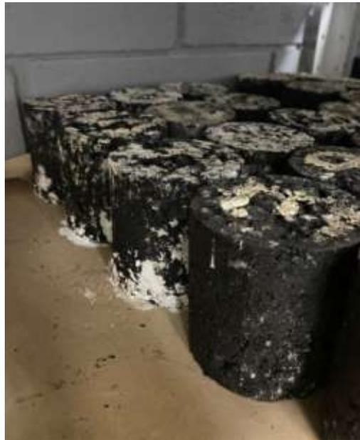
**Figura 4. Efeito carbonatador sobre as amostras condicionadas em água no ensaio de Duriez.**
