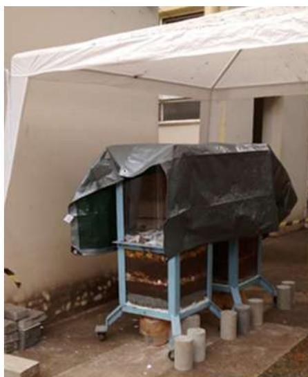
Figura 4. Protótipos de solo e de solo + 70% ADF nas camadas de cobertura de resíduos sólidos orgânicos.
