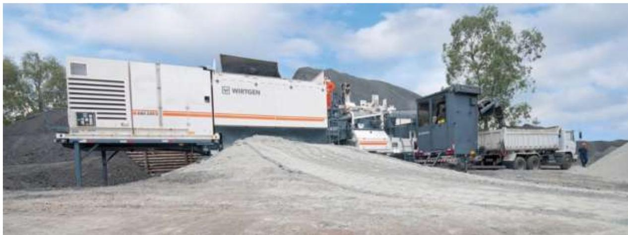
**Figura 3 - Usina móvel de reciclagem com espuma de asfalto tipo KMA.**
