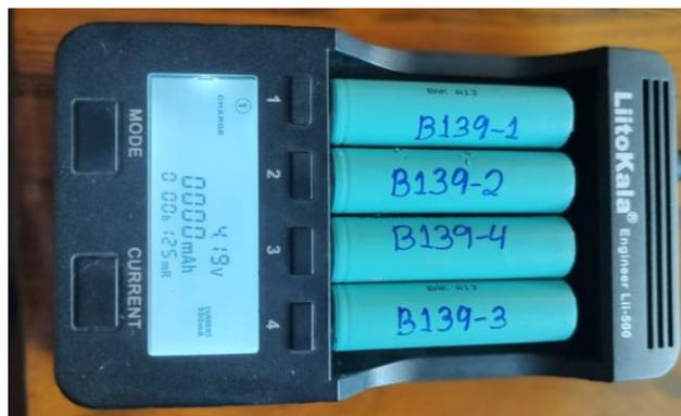
**Figura 6: Carregador inteligente LiitoKala Engineer LII-500 testando um conjunto de células**
