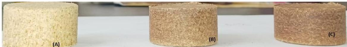
**Figura 3: Briquetes de sisal puro (A), sisal+lignina 9:1 (B) e sisal+lignina 8:2 (C).**
