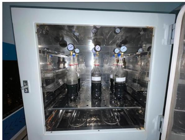
**Figura 1: Biorreatores dispostos na estufa.**
