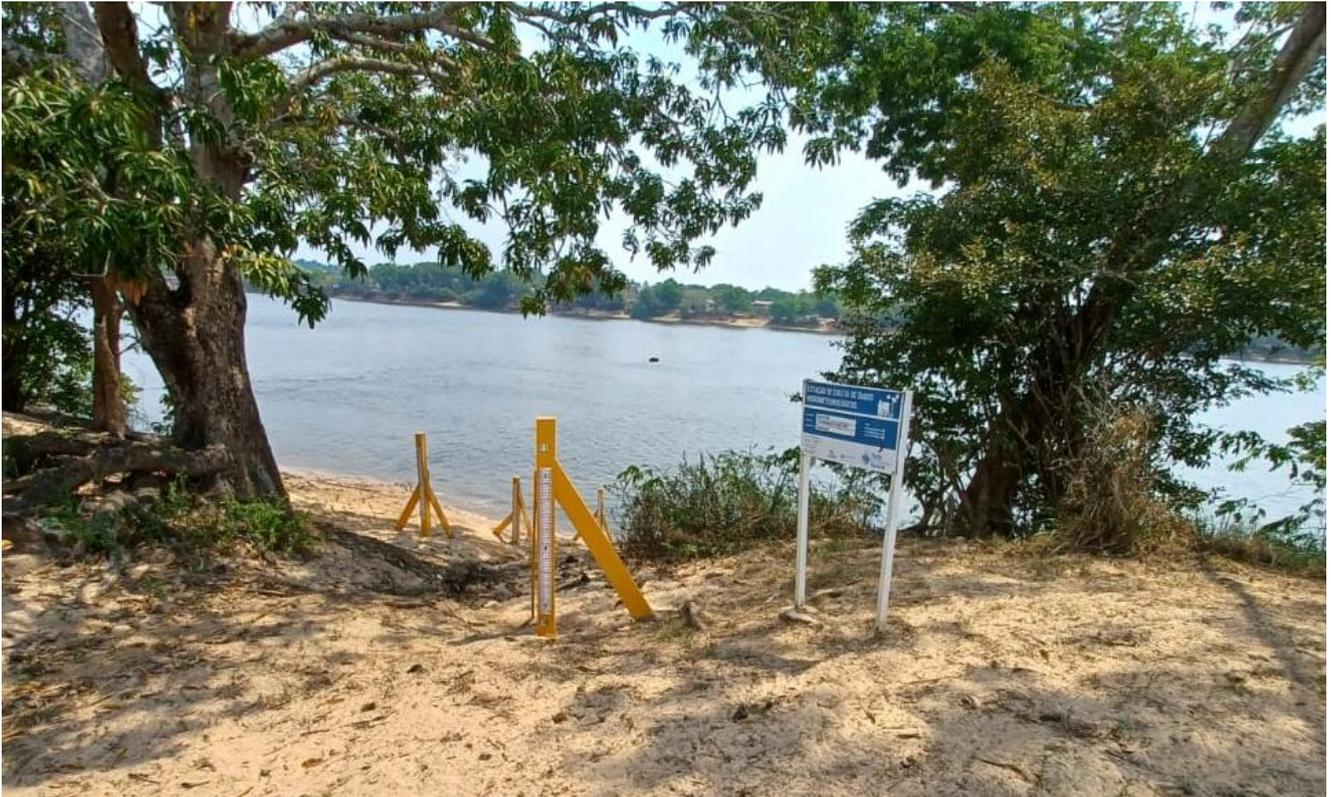
Figura 05: Seção de réguas linimétricas da estação Ji-Paraná.
