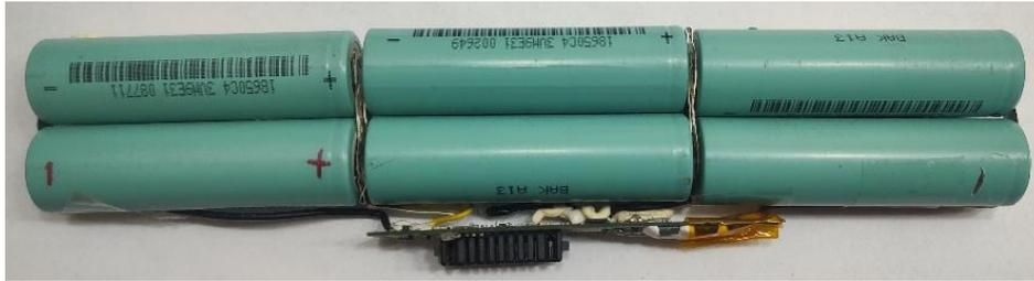
**Figura 4: Dentro da bateria na Fig. (3) antes que as células sejam separadas**
