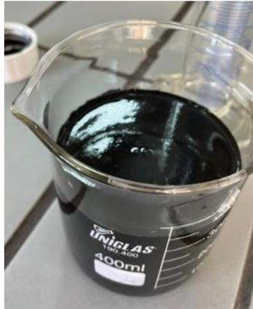
**Figura 5: Lodo coletado na ETE Serraria.**
