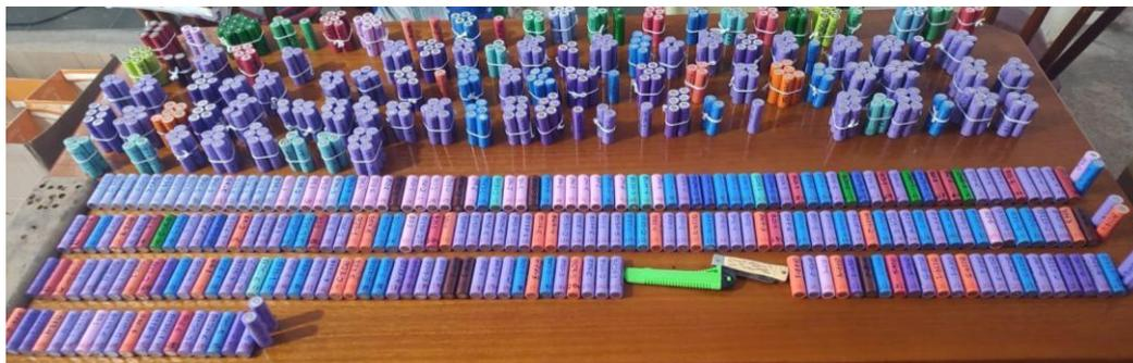
**Figura 5: Baterias de células sendo separadas e catalogadas após o desmonte e tratamento das baterias de notebook**
