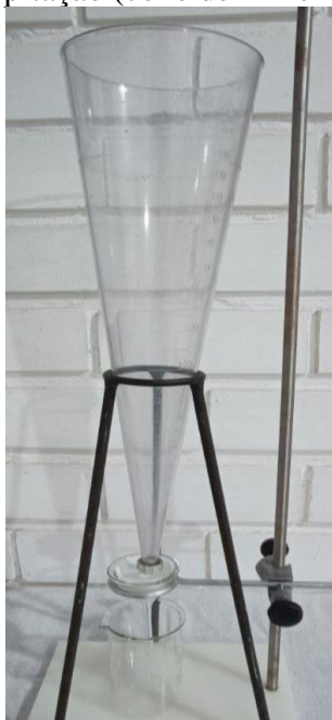
Figura 15: Sistema utilizado para precipitação (cone de Imhoff e filtro de papel qualitativo)
