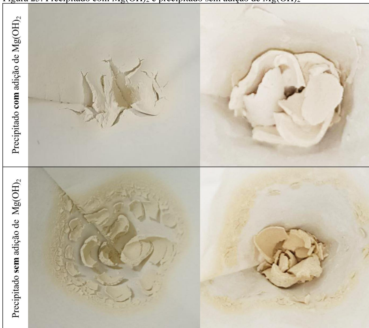
Figura 25: Precipitado com Mg(OH)_2 e precipitado sem adição de Mg(OH)_2
