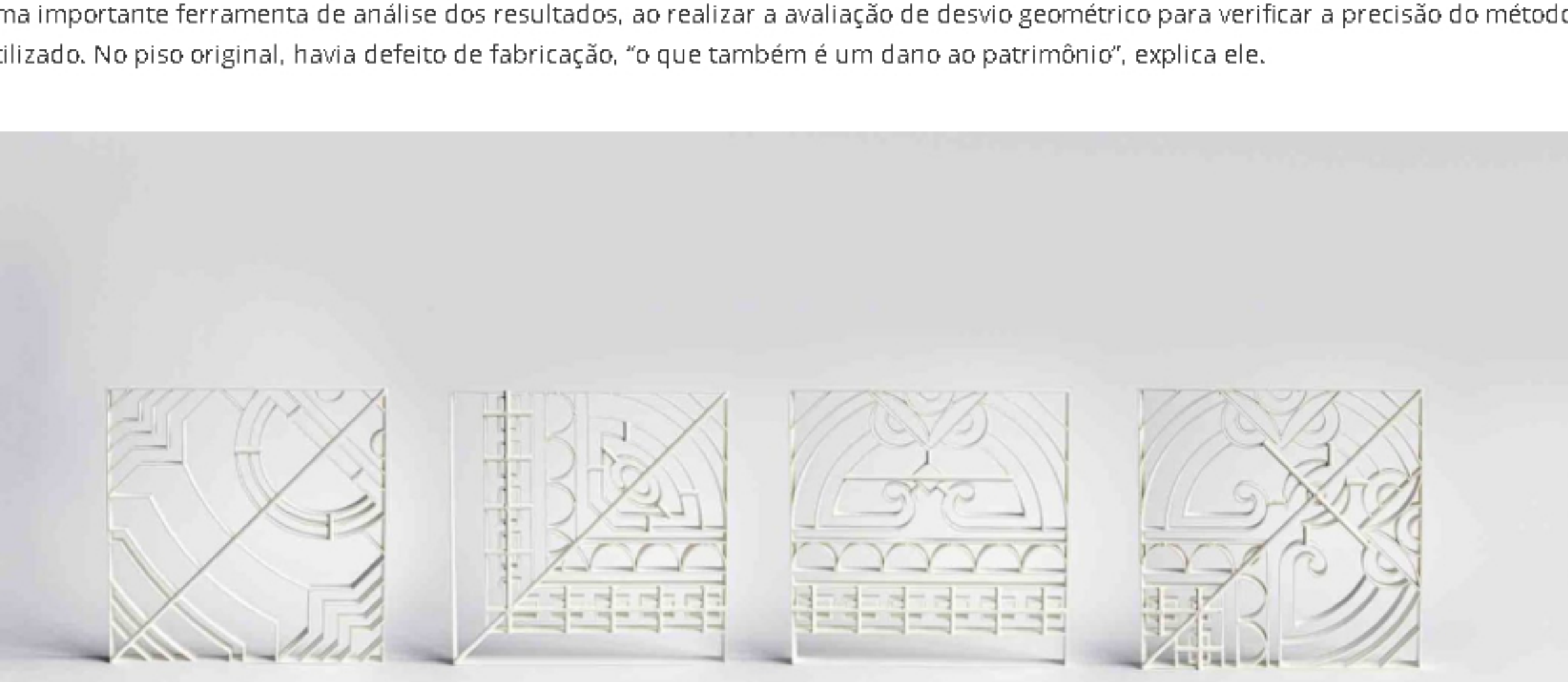
Moldes produzidos na Impressora 3D do Laboratório de Design e Seleção de Materiais da UFRGS com a finalidade de agilizar o processo e tornar os desenhos dos novos ladrilhos mais precisos. (Foto: Thiago Thamy/Divulgação)
