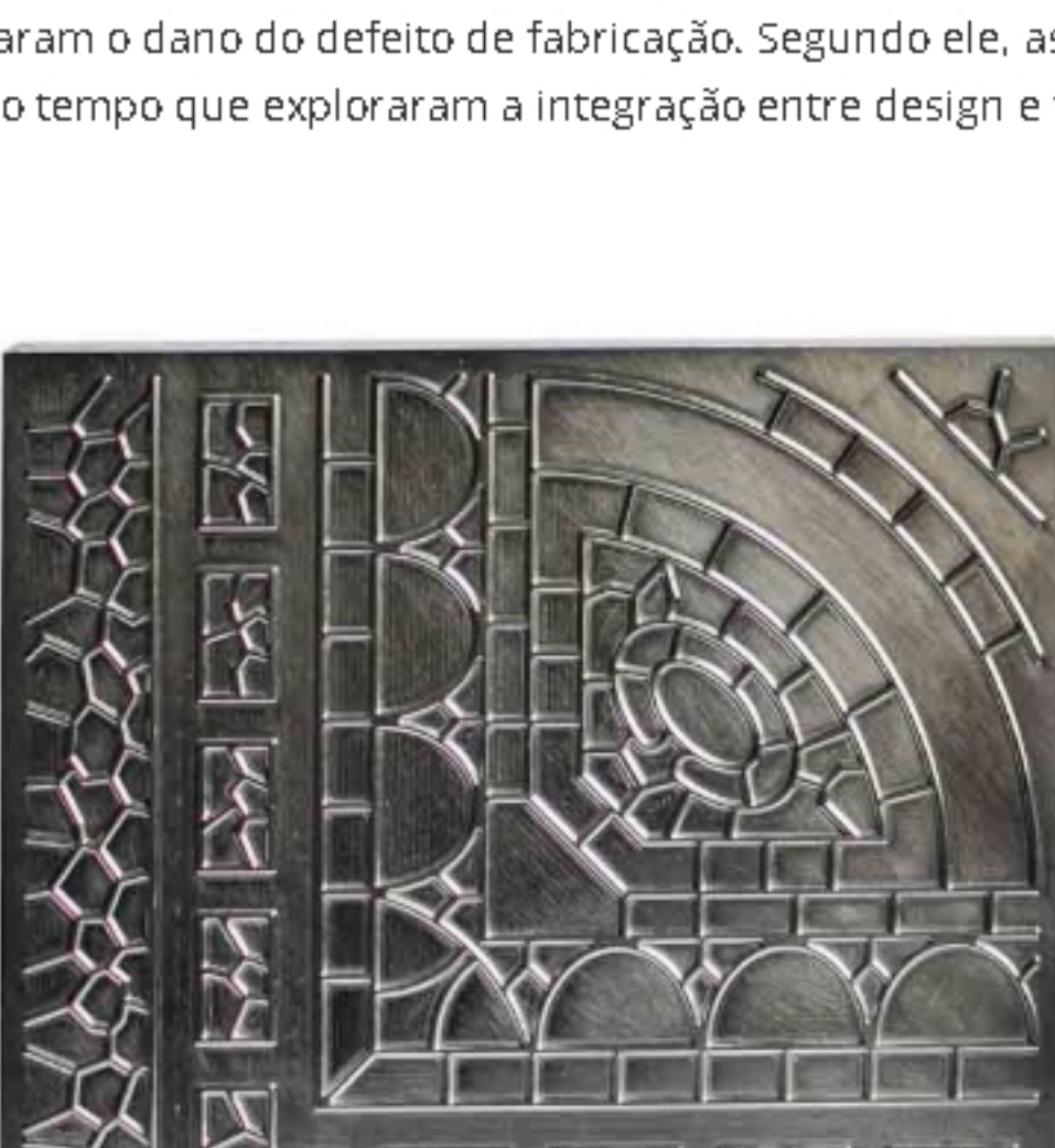
Uma das matrizes de aço produzidas pela pesquisa e usadas para confecção dos ladrilhos com os padrões do Paço Municipal. (Foto: Thiago Thamy/Divulgação)
