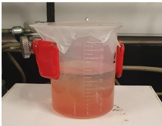
**Figura 25.** Procedimento de troca iônica com resina Amberlite®.
