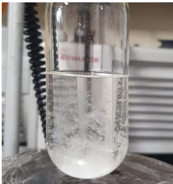
**Figura 78.** Carbonato de propileno em acetona contendo o catalisador AmFAM.Br2 após a primeira filtração.
