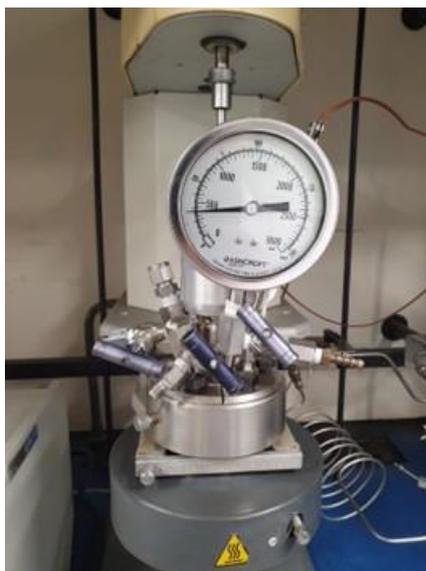
**Figura 30.** Reator Parr com capacidade de 100 mL no qual foram conduzidas as reações de cicloadição de CO<sub>2</sub> a óxido de propileno.
