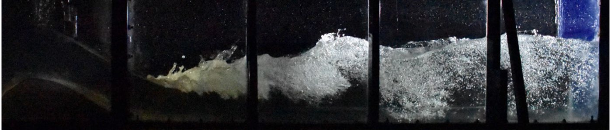
Figura 2.7 – Ressalto hidráulico formado para vazão específica q = 0,375 \text{ m}^2/\text{s} e F_1 = 1,9 . Steinke (2020).
